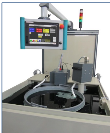
Beschichtungsstation der DBE-1/100x120x80 mit Beschichtungskassette, Rotationseinheit, Hebe-/Senkeinrichtung
